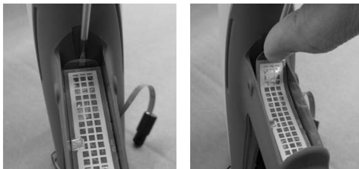
Рис. 6-8 Снятие выключателя спускового устройства с рукоятки
